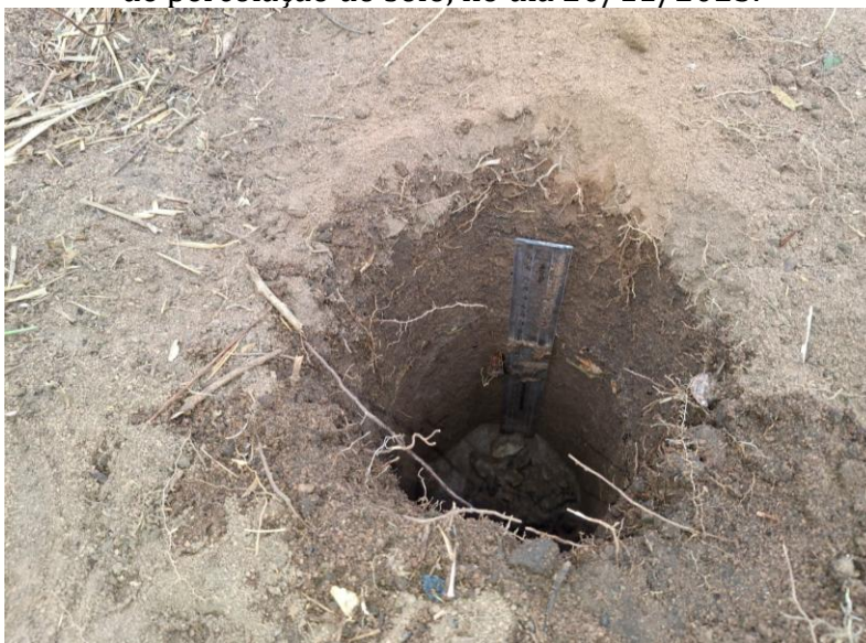
FOTO 04 – Queda do nível d'água das cavas na realização do ensaio para estimar a capacidade de percolação do solo, no dia 20/11/2025.
