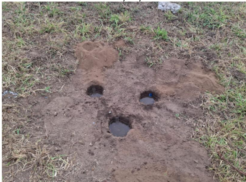
FOTO 01 – Cavas para realização do ensaio para estimar a capacidade de percolação do solo no dia 20/11/2025.
