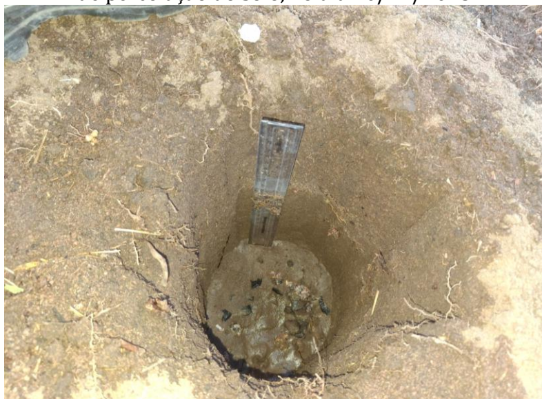
FOTO 02 – Queda do nível d'água das cavas na realização do ensaio para estimar a capacidade de percolação do solo, no dia 20/11/2025.
