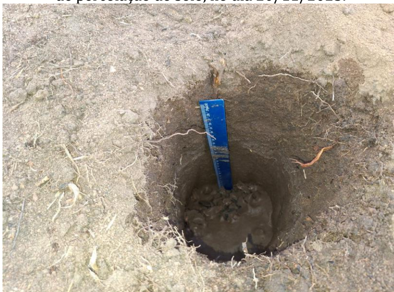
FOTO 03 – Queda do nível d'água das cavas na realização do ensaio para estimar a capacidade de percolação do solo, no dia 20/11/2025.
